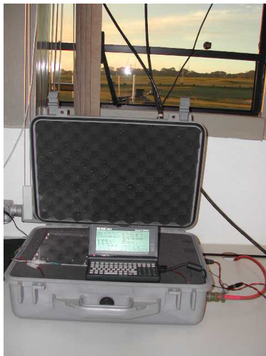
Figura 4.1: Circuito do magnetômetro fluxgate instalado no Observatório Espacial do Sul –OES/CRS/INPE - MCT. Fonte: LFSMIM/CRS/INPE - MCT
